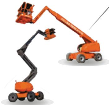
Permettant d'atteindre une hauteur de 14 à 41 mètres selon les engins, les nacelles élévatrices sont compactes et polyvalentes, elles facilitent le travail de la personne élevée. En fonction des équipements, le périmètre d'accessibilité est plus grand conférant ainsi une marge de manœuvre plus étendue, elles donnent donc accès à de grandes hauteurs quel que soient le type de façade ou les obstacles
