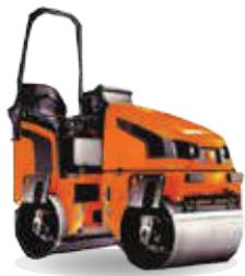
également appelés rouleaux compresseurs, ces engins, permettent grâce aux deux cylindres qui leur tiennent lieu de roues de tasser et de lisser aussi bien un sol remblayé que l'enrobé d'une route. Ils sont particulièrement préconisés pour le compactage de grande superficie
